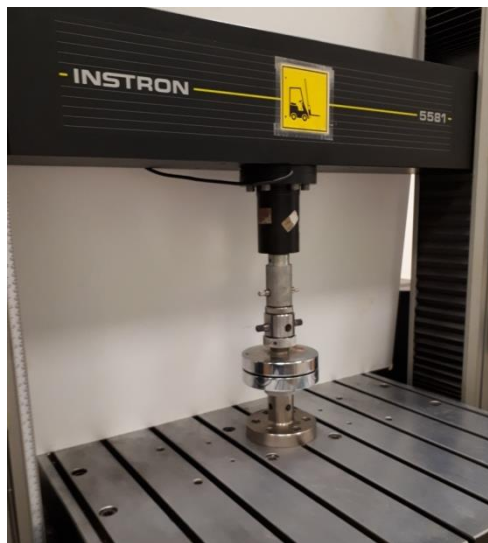
3.9. ábra A szemcsék nyomóvizsgálatokhoz használt nyomólapok
