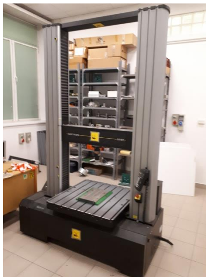
3.8. ábra Az INSTRON 5581-es anyagvizsgáló berendezés
