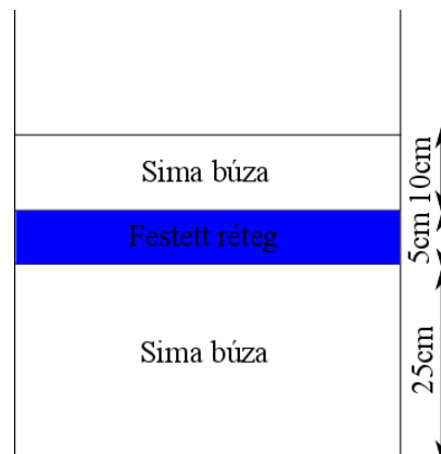
3.3. ábra Az egyes rétegek elhelyezkedése a tartályban
