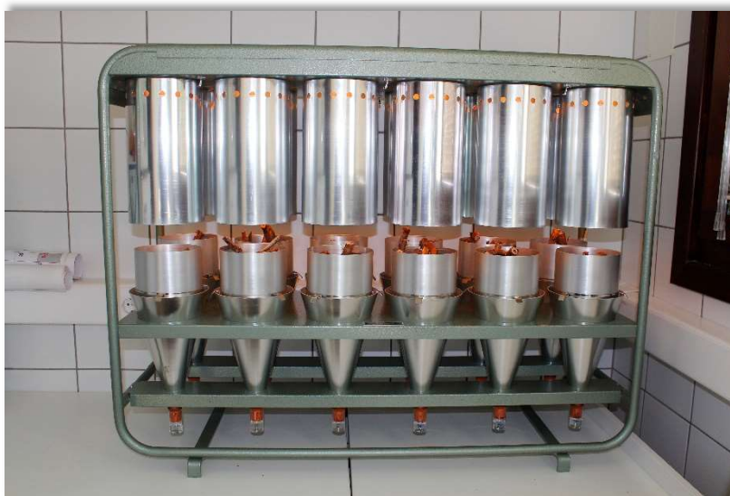
5. ábra. Tölcséses atkafuttató berendezés ölfóhállal
