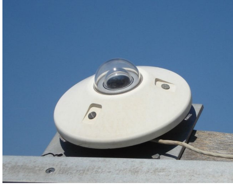
2.2. ábra Kipp & Zonen CM-11 típusú piranométer direkt és szórt napsugárzás mérésére (SZIE)
