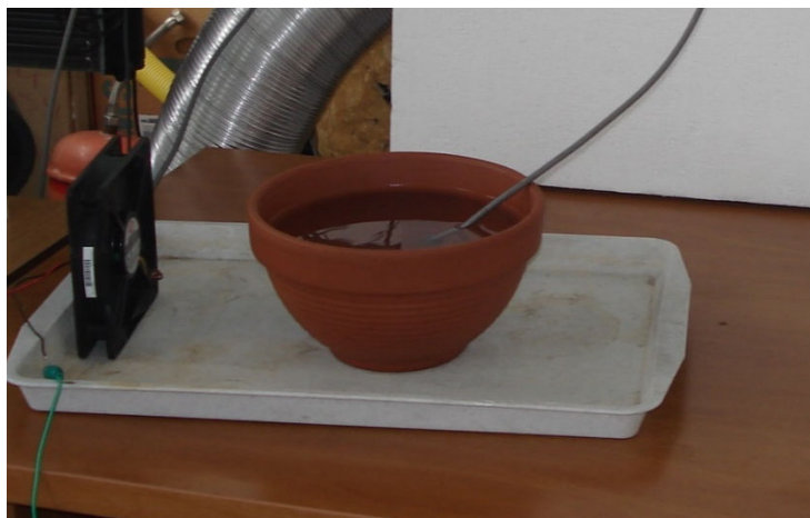
3.8. ábra Nyitott agyagedény víztartalmának párolgatótása ventilátorral (SZIE)
