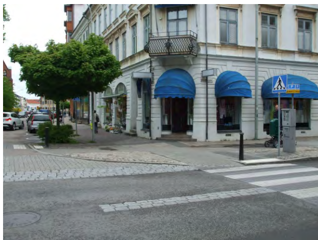
324-325. a látássérültek a süllyesztett szegélyt nem érzékelik, mégis a kiemelt szegély van taktilis figyelmeztetésával jelezve
