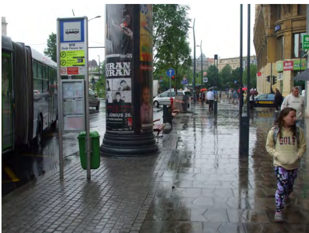
441-442. az első ajtó helye nem jelzett a burkolatban, megtalálását semmi nem könnyíti; kerekesszékkal a peron használható
