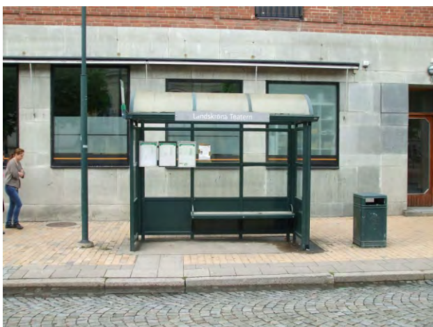
455-456. első ajtó helye TWSI-vel jelölve; a fedett utasváróban kerekesszékeknek is elegendő szabad hely a pad mellett
