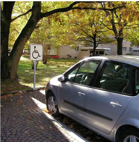
428-430. táblával és felfestéssel jelölt akadálymentes parkolóállás; a kiszállás a magasabban levő járdára történik, ami nehéz manőver
