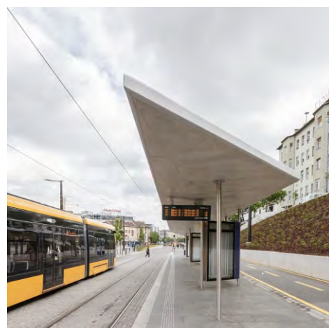
468-469. a figyelmeztető jelzés meghaladható akadályt jelez: érintettek beszámolója szerint a peront gyakran összetévesztik az átkelővel
