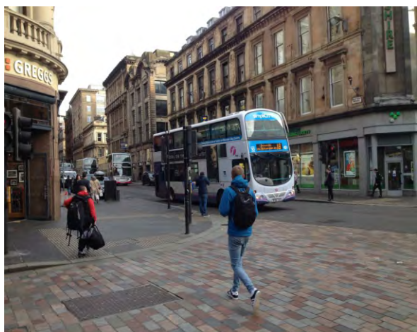
358-360. a rávezetés is figyelmeztetőelemekkel történik; az átkelést az útburkolaton nem jelölik, így hiányzik a vizuális kontraszt
