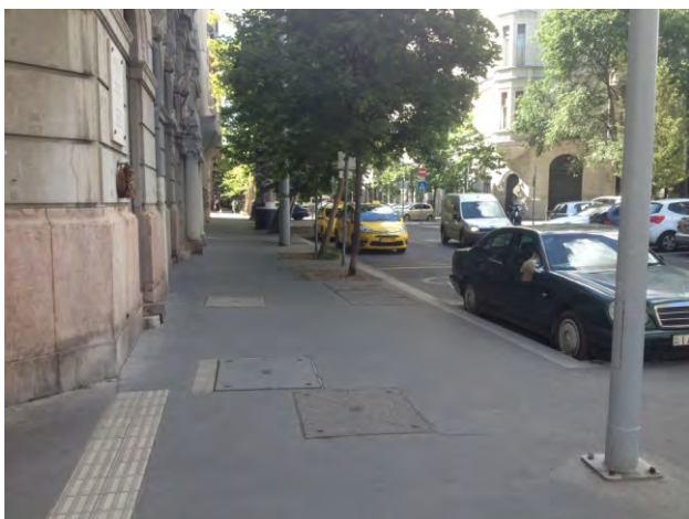
305-306. a Szabadság tér felé közeledve a hagyományos, térkő-elemes taktilis jelzésrendszert alkalmazták...
