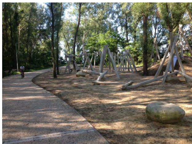
728-729. kavicsfix-burkolat parti sétányon, amelyet gördülőeszközökkel is akadálymentesen lehet használni
