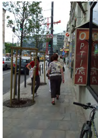
151-153. a homlokzat követését nehezítő tereptárgyak (különösen a látássérültek által nem érzékelhető konzolos elemek) veszélyt jelentenek
