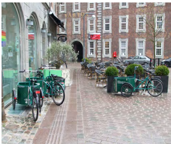
214-216. egyedi mesterséges taktilis jelzések egyedi terméskő burkolatban; mobil és rögzített akadályok a vezetősávon, fokozott veszély
