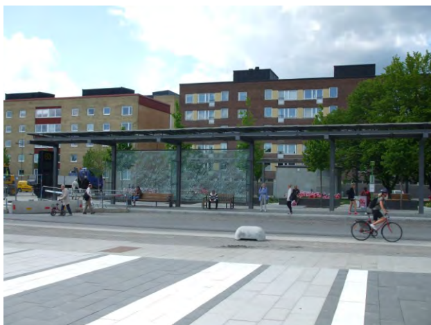
457-458. burkolati mintázattal, és a zöldsávok kontrasztjával orientáló kialakítás buszpályaudvaron
