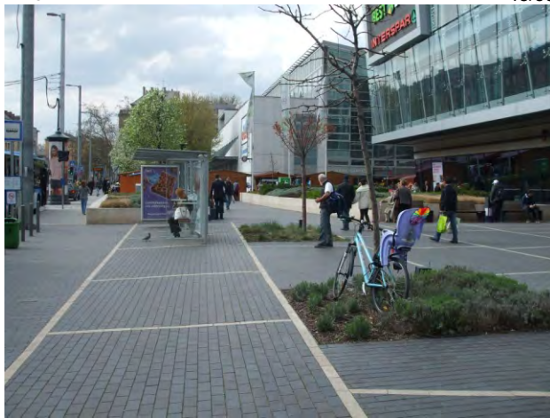
443-444. a megálló megtalálását a burkolatminta és a kiemelt növénykazetta segíti; az első ajtó nem jelzett; kerekesszékekkel használható
