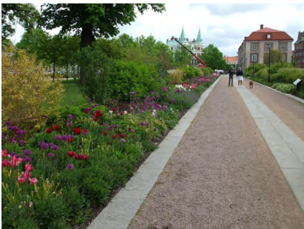
566-567. a stabilizált burkolattal kontrasztos szegély, ill. a kapcsolódó növényfelületek természetes vezetőelemként szolgálnak
