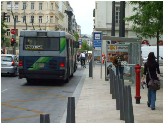
436-437. az első ajtó helye nem jelzett a burkolatban, megtalálását semmi nem könnyíti; kerekesszékkal a peron használható
