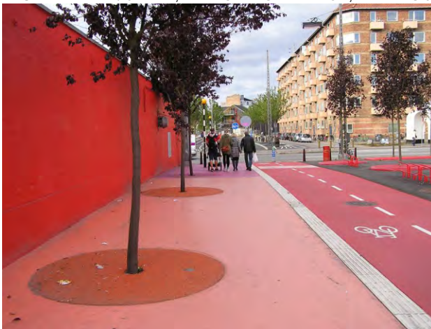
240-241. vezetősáv egyik oldala a kerékpárúton, ami nem biztonságos, hanem veszélyes útvonal!
