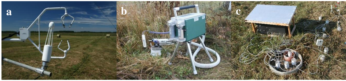
4. kép: A mérésekhez használt műszerek. Eddy-kovariancia rendszer (a), LICOR-6400-as infravörös gázanalizátor a hozzá tartozó talajlégzés-mérő kamrával és a műszerhez kapcsolt talajhőmérővel (b), az automata talajlégzés-mérő rendszer (ASRS) 10 db talajlégzés-mérő kamrával (c).
