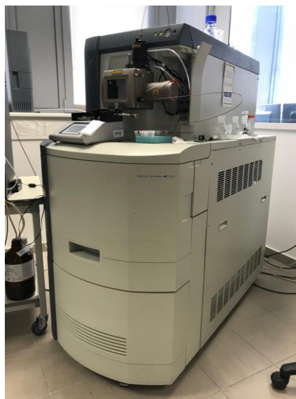
10. ábra – A pontos tömegméréshez alkalmazott ESI-TOF-MS műszer
