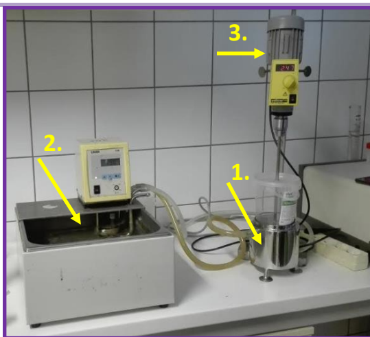
6. ábra: extraháló berendezés SZIE ÉTK Élelmiszeripari Műveletek és Gépek Tanszék (Saját fotó) (Az extraktor részei: 1. Duplikátor, 2. Termosztát, 3. Keverőmotor)
