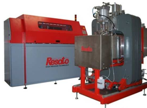
11. ábra Resato FPU 100-2000 HHP berendezés a nyomásfokozó egységgel (b) és a kezelőkamrával (j)
