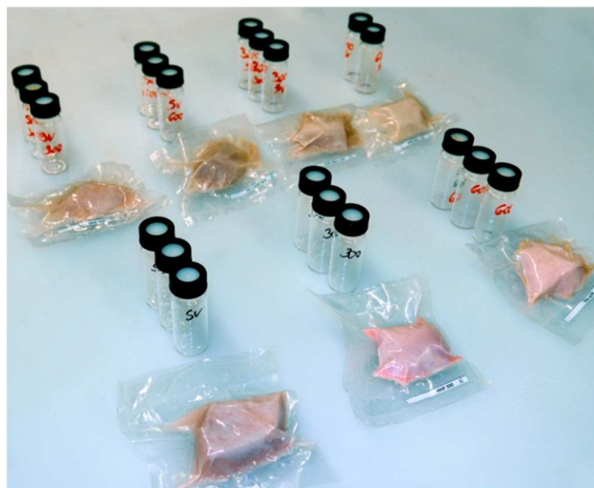
26. ábra Elektronikus orr vizsgálatra készült karaj minták és a mintatartó üvegcsék
