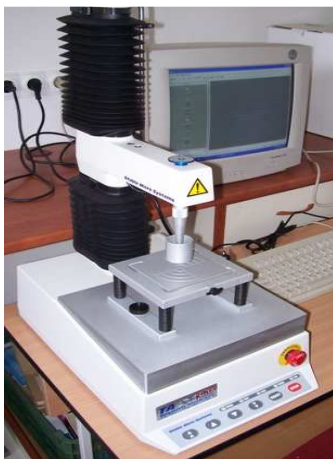
16. ábra SMS TA XT plus állománymérő berendezés és a mérőfejek: P2/N tű; P/0.5S gömb
