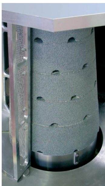
3.5. ábra A Schule Verticone intenzív felülettisztító gépek csiszolókövei
