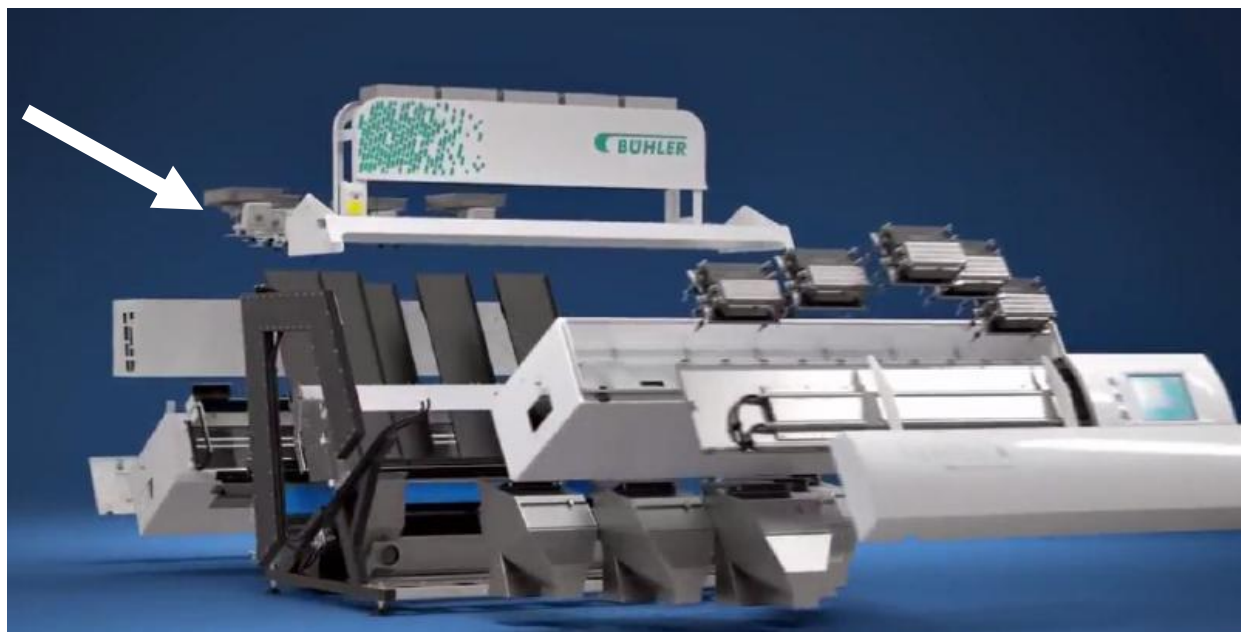
2.4. ábra Optikai válogatógép részegységei (forrás: https://www.youtube.com )
