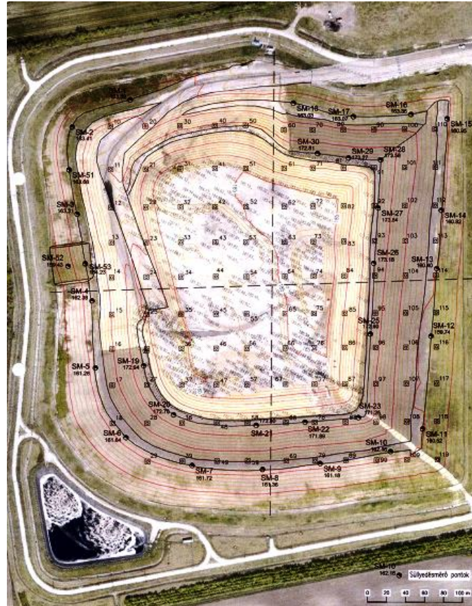
4.31. ábra A PRHK SM-1-53 süllyedésmérő kövek helyszínrajzi elhelyezkedése (FKF Zrt.)k
