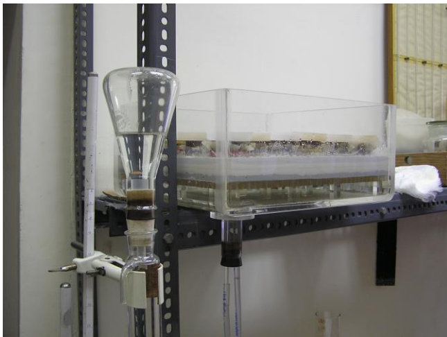
3.6. ábra MTA-TAKI víztartási görbe mérése
