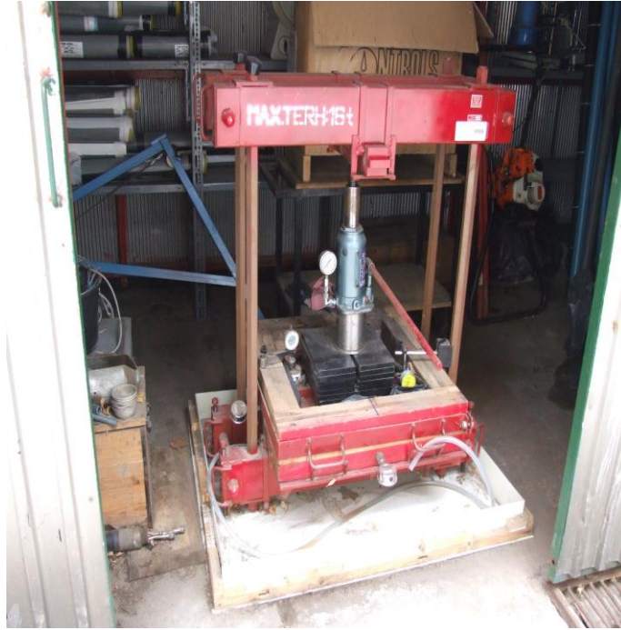
3.5. ábra SZIE-YMÉTK-ÉI-GTL a nagyméretű ödométer
