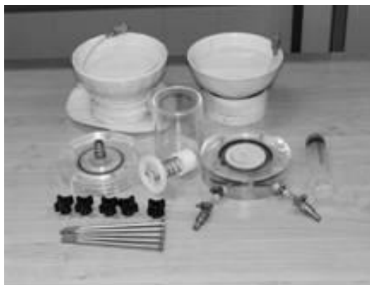
3.28. ábra Feszültségkamrás alapkészülék szétszerelt állapotban
