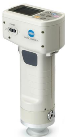
17. ábra: MINOLTA CR-400 típusú tristimulusos színmérő készülék.
