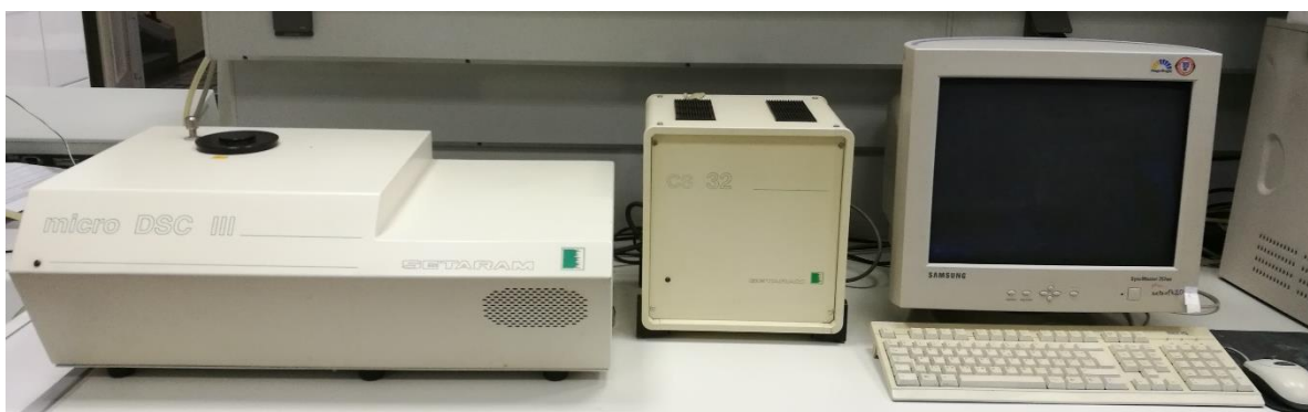
21. ábra: Micro DSC III mikrokaloriméter (Setaram, Franciaország).
