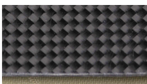
2. ábra Textil kompozit lemez felülnézete
